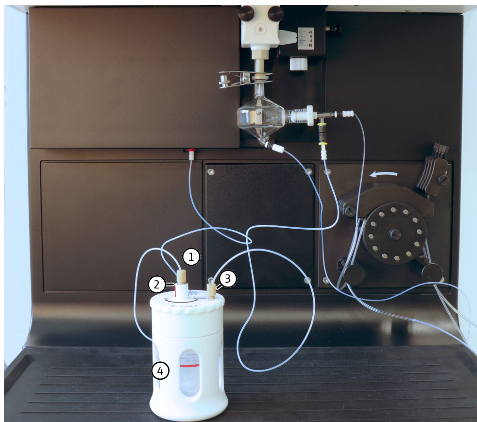
図 33 アルゴン加湿器の設置
