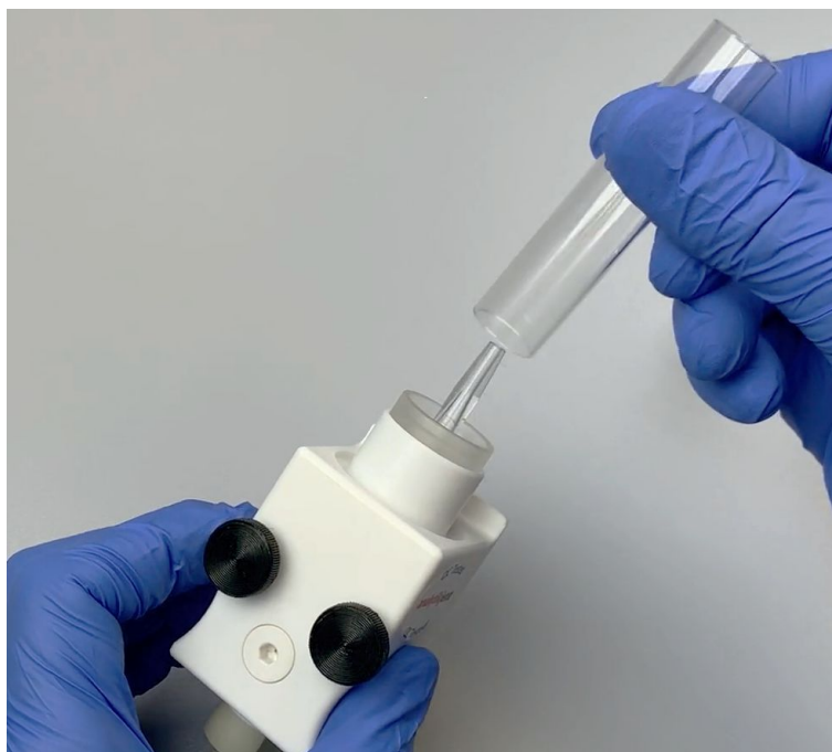
Rys. 37 Film: Czyszczenie palnika rozbieralnego (dostępny w pomocy online)
