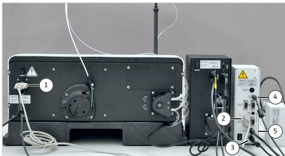
Rys. 27 Podłączanie jednostki sterującej zaworu przełączającego
