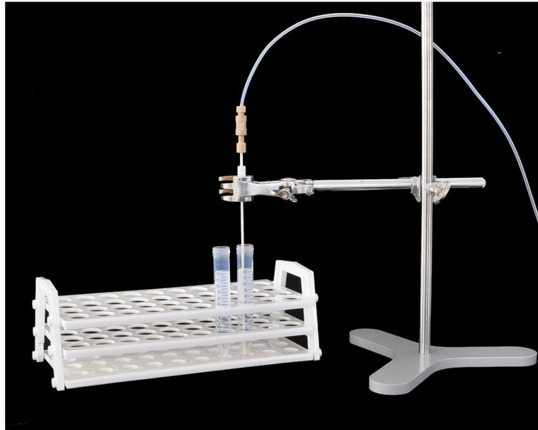
Fig. 27 Fixer la canule sur le pied
