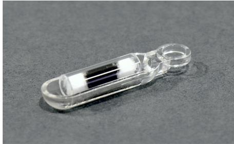
Fig. 25 Nacelles avec conteneur de quartz
