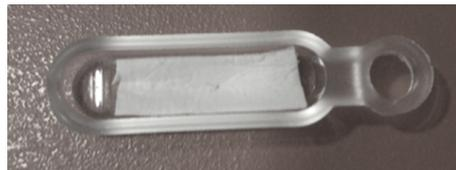
**Abb. 24** Quarzschiffchen mit korrekt eingelegtem Quarzvlies
