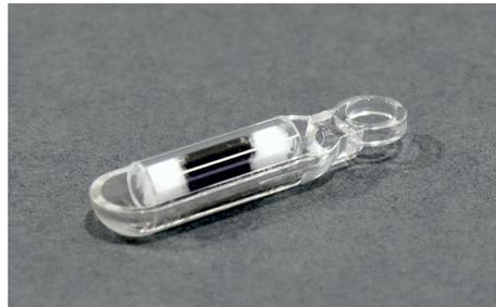
**Abb. 25** Schiffchen mit Quarzcontainer
