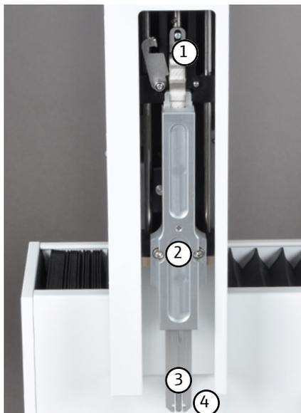
**Изобр. 6 Выталкивающий инструмент, установленный в инжекционную головку**
