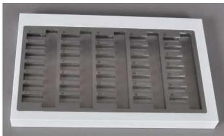
Изобр. 8 Планшет для АОХ-проб, твердых проб, высоковязких жидкостей
