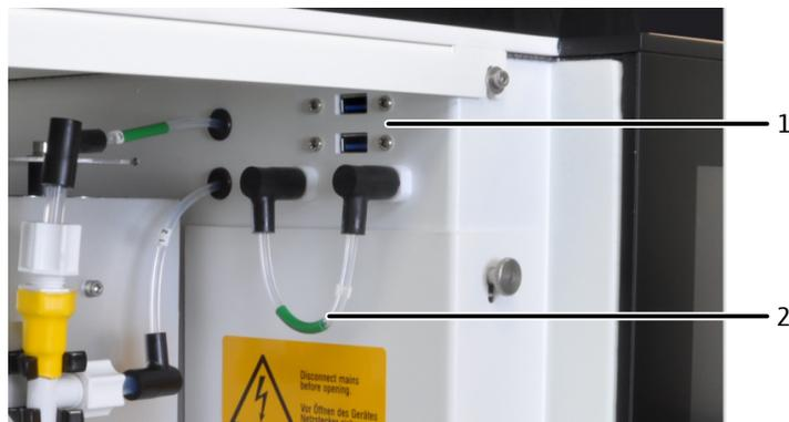
**Изобр. 17** Интерфейсы USB и трубка-мостик в линии газа за передней дверцей
