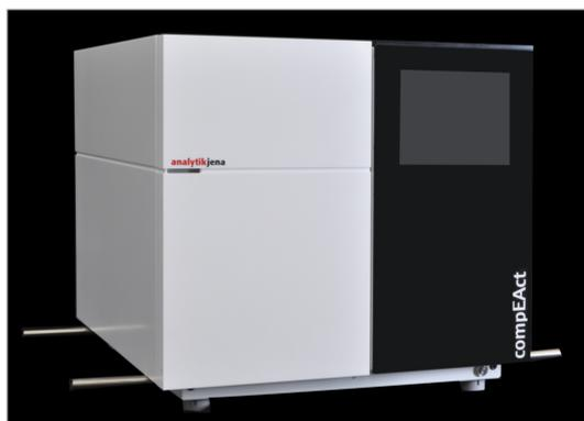
Изобр. 24 Устройство с привинченными транспортировочными ручками
