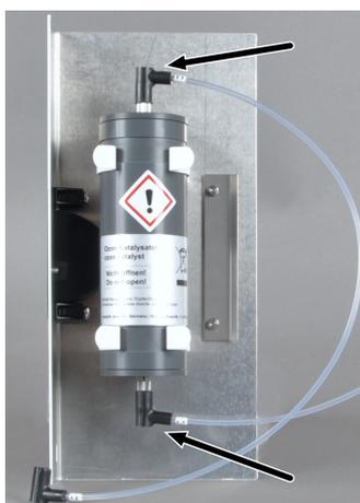
**Изобр. 23** Химический деозонатор на выдвинутой инспекционной крышке; стрелками отмечены быстроразъемные соединения, которые необходимо снять
