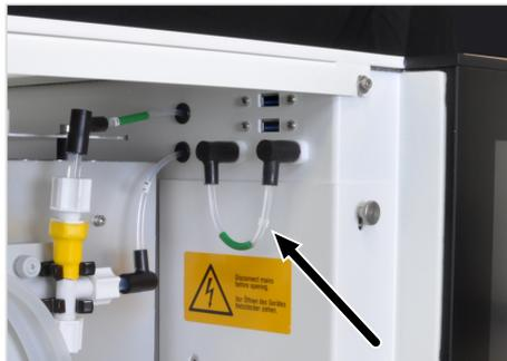
Изобр. 22 Трубка-мостик (трубка 7)
