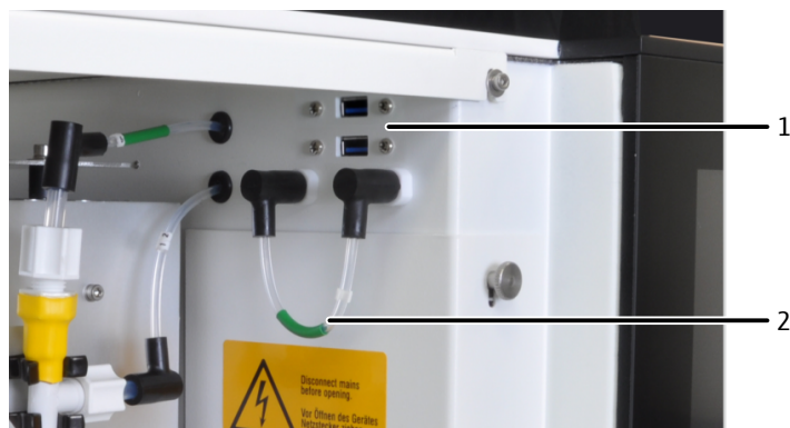
Изобр. 18 Интерфейсы USB и трубка-мостик в линии газа за передней дверцей
