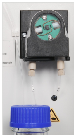
Изобр. 7 Насос фосфорной кислоты
