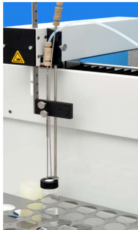
Изобр. 45 Положение игл для измерений NPOC с одновременным (слева) и неодновременным (справа) выдуванием
