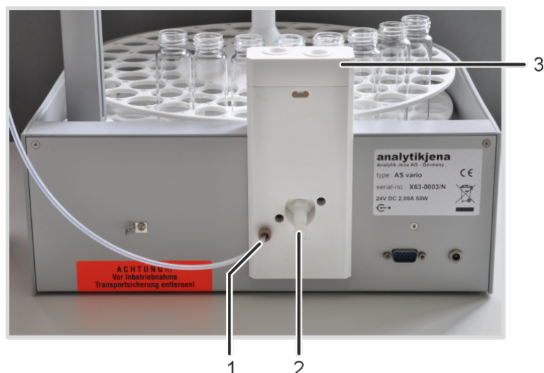
Изобр. 37 Система промывки игл в модели AS vario ER
