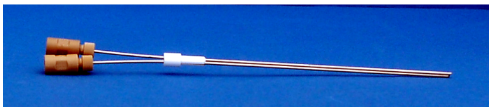
Изобр. 35 Втулка с двумя иглами для неодновременного продувания
