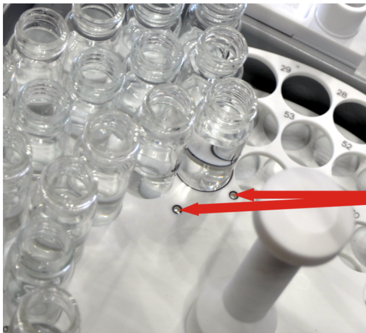
Изобр. 58 Юстировочные точки на планшете для проб
