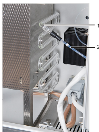
Fig. 11 Serpentina di condensazione
