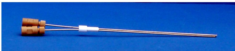
Fig. 35 Manicotto con due cannule per un'espulsione non parallela
