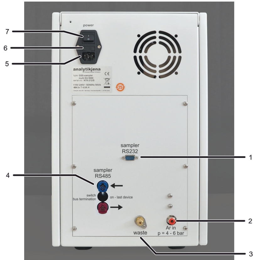
Bild 7 Geräterückseite des GSS Moduls mit Schnittstellen und Geräteschalter
