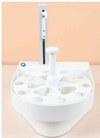
**Fig. 23 Distributeur d'échantillons AS 10e**
