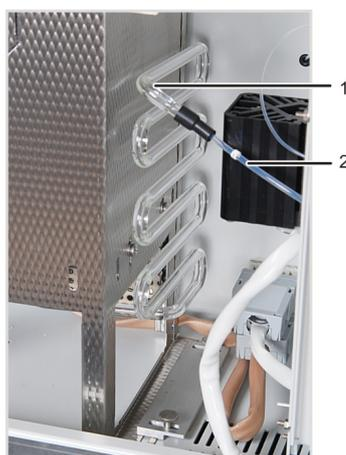
Fig. 11 Serpentin de condensation
