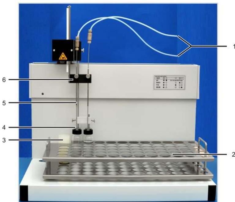
**Fig. 39 Distributeur d'échantillons EPA Sampler**
