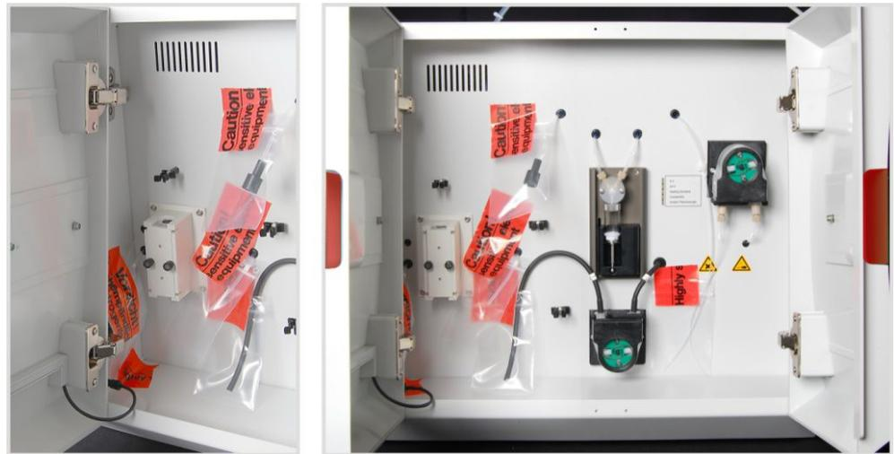
**Fig. 75 Composants situés derrière les portes avant attachés pour le transport**
