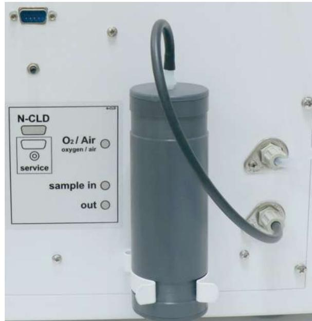
**Fig. 74 Remplacement de la cartouche de l'adsorbant**
