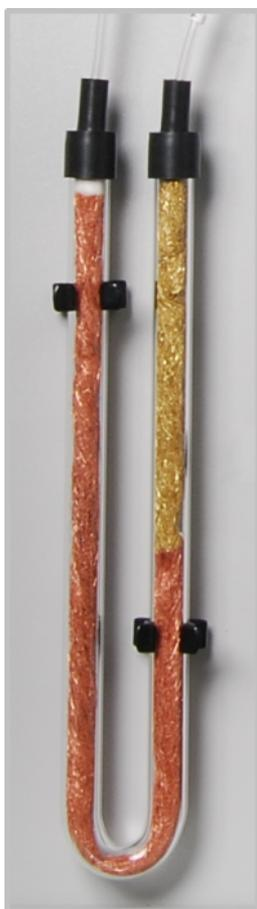
**Fig. 14 Piège à halogènes**
