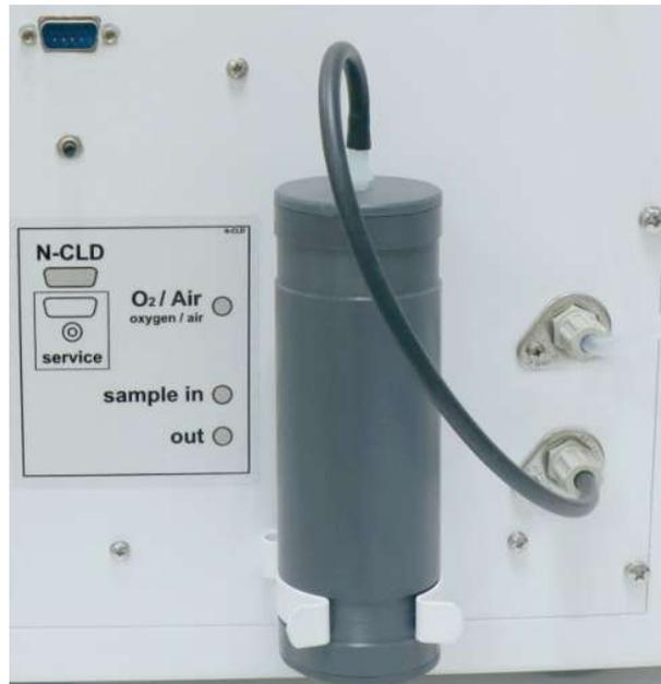
**Abb. 74 Adsorberpatrone wechseln**
