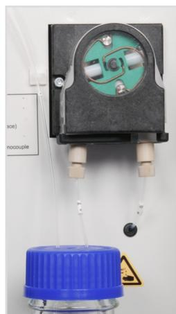
**Abb. 7 Phosphorsäure-Pumpe**
