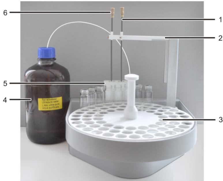
**Abb. 33 Aufbau des Probengebers AS vario ER**
