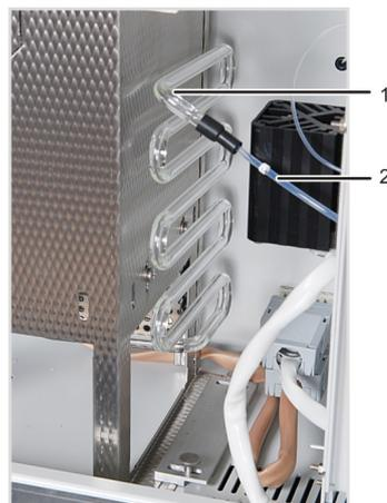
Abb. 11 Kondensationsschlange
