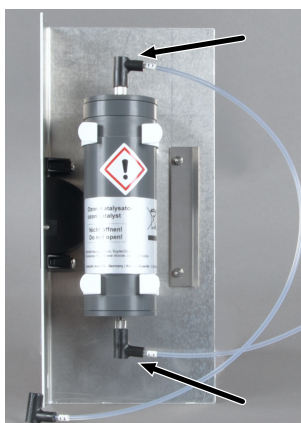
Fig. 23 Destructeur d'ozone chimique sur le clapet de révision retiré ; les connecteurs FAST à retirer sont indiqués par des flèches
