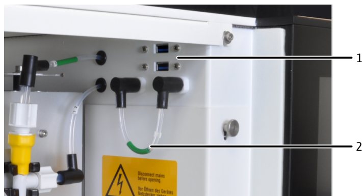
Fig. 17 Interfaces USB et tube en U sur le trajet de gaz derrière la porte avant
