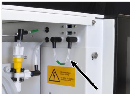
**Fig. 23 Tube en U (tuyau 7)**
