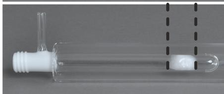
**i** REMARQUE ! Le bouchon ne doit pas obstruer la fente au fond du tube intérieur. Le bouchon doit couvrir toute la section transversale du tube intérieur. En vue de dessus, la fente dans le tube ne doit plus être visible.
