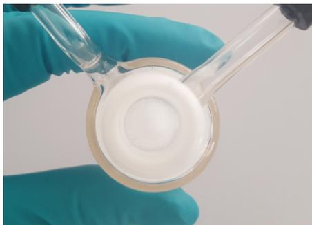
Après avoir changé la laine de quartz, le système d'analyse doit être nettoyé par au moins 3 mesures avec un solvant pur (par ex. isooctane, toluène, xylène). Répéter les mesures à blanc jusqu'à ce que la valeur à blanc d'azote soit inférieure à 20 AU/ $\mu$ l de solvant (AU/ $\mu$ l : unités de surface par microlitre de solvant). La valeur à blanc peut varier en fonction du solvant utilisé.
