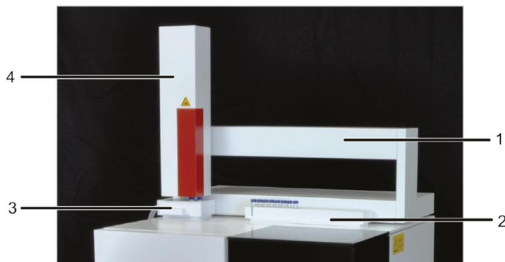
**Fig. 12** Passeur d'échantillons LS
