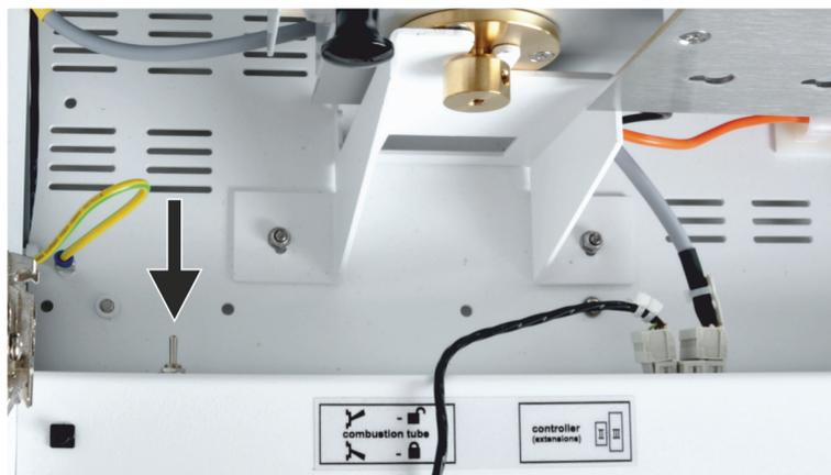
Abb. 17 Kippschalter Verriegelung/Freigabe Verbrennungsrohr
