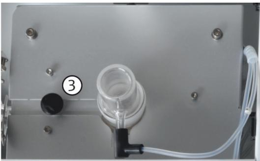
7. Die Hitzebrücke im Ausschnitt des Ofens über dem Gasausgang des Verbrennungsrohres anbringen.
