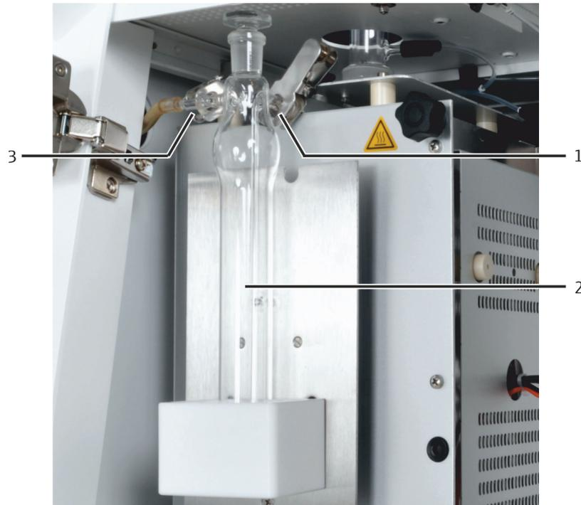
Abb. 15 Schwefelsäuregefäß (vertikal) in der Standardvariante
