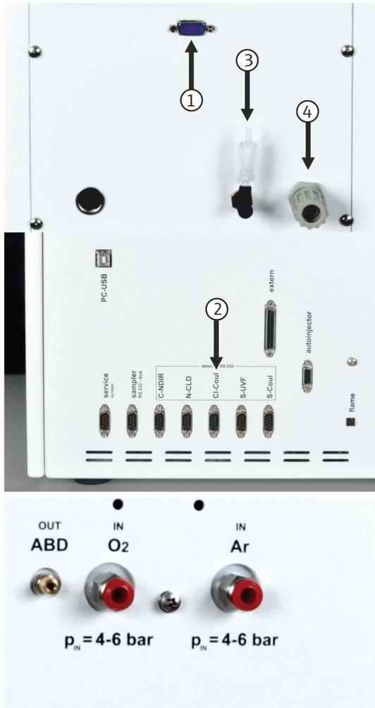
2. Den multi X 2500 und das Chlormodul über das serielle Kabel miteinander verbinden.
