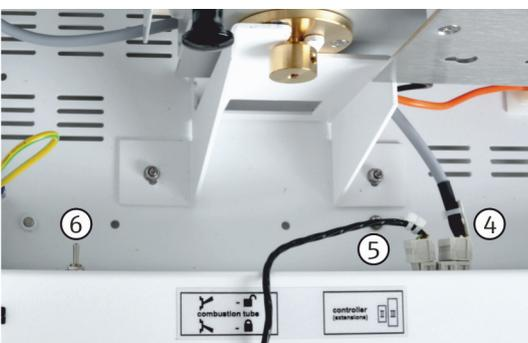
7. Die elektrischen Anschlüsse für die Auto-Protection-Baugruppe (4) und für die Gastransferleitung (5) in die Anschlüsse stecken.
