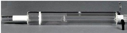
10. Das Verbrennungsrohr auf übermäßige Kristallisation, Risse und ausgeplatzte Stellen kontrollieren. Nur intakte Verbrennungsrohre wieder verwenden.
