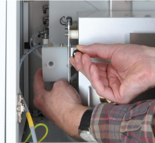
11. Mit der linken Hand die Auto-Protection-Baugruppe halten und mit der rechten Hand am Knauf der Klemmhalterung ziehen, um die Verriegelung zu öffnen.
