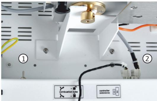
5. Die pneumatische Dichtung an der Auto-Protection-Baugruppe öffnen. Kippschalter (1) dafür nach oben umlegen.
