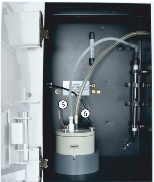
5. Den Gasausgang der Messzelle (5) über die Saugolive und den Schlauch Nr. 5 mit dem oberen Ende des Adsorptionsrohrs verbinden.
