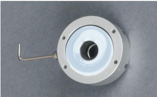
3. Gehäuse mit pneumatischer Dichtung aus der Auto-Protection-Baugruppe entnehmen.
