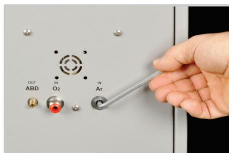
6. Den innenliegenden Partikelfilter mit einem 5 mm-Innensechskantschlüssel herausschrauben.
