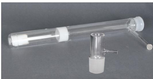
10. Das Verbrennungsrohr auf übermäßige Kristallisation, Risse und ausgeplatzte Stellen prüfen. Nur intakte Verbrennungsrohre erneut verwenden.
