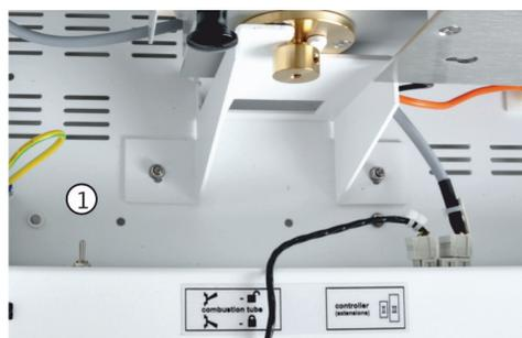
8. Die pneumatische Dichtung zur Auto-Protection-Baugruppe schließen. Dafür Kippschalter (1) nach unten kippen.
