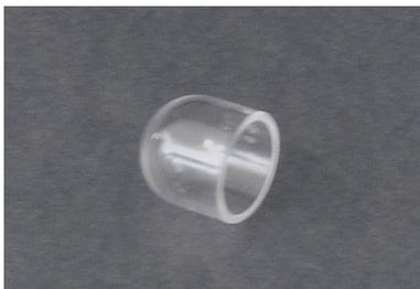
Den Quarztiegel mit einer Pinzette in das offene Verbrennungsrohr einsetzen.
