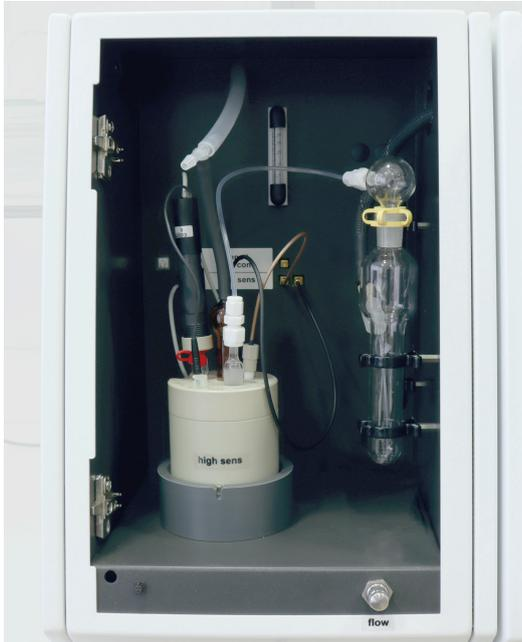
1. Die Messzelle "high sensitive" mit Magnetrührstab und Deckel in das Chlormodul einsetzen.
