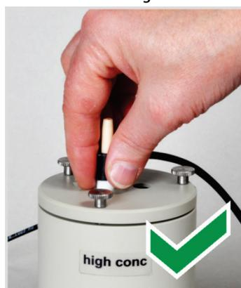
Umfassen Sie die Elektrode von oben und ziehen Sie die Elektrode gerade nach oben aus dem Deckel.
