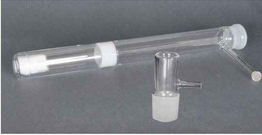
4. Vorsichtig einen Quarzwollepropfen bis zum Boden in das offene Verbrennungsrohr hineinschieben.
