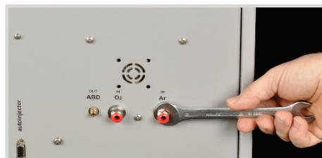
5. Die Gasanschlüsse mit 13 mm-Maulschlüssel abschrauben.
