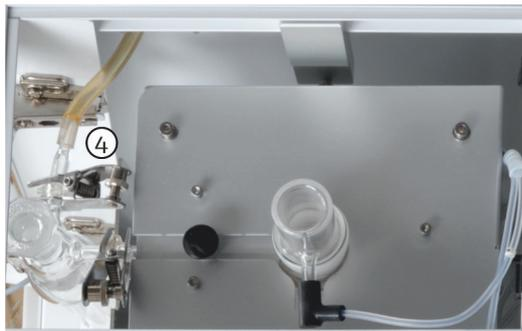
6. Den Messgasschlauch (4) über den Kugelschliffadapter an das Schwefelsäuregefäß anschließen. Die Verbindung mit einer Gabelklemme sichern.
