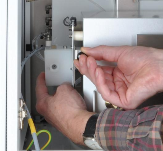
3. Mit der linken Hand die Auto-Protection-Baugruppe halten und mit der rechten Hand am Knauf der Klemmhalterung ziehen, um die Verriegelung zu öffnen.
