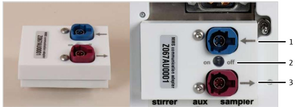
**Fig. 14** Connecteur pour le raccordement à l'analyseur (à droite : monté sur le distributeur d'échantillons)
