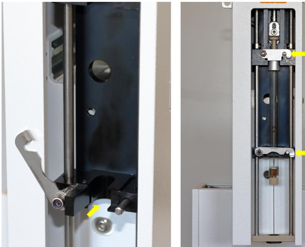
Fig. 23 Adaptateur de seringue et languettes de verrouillage.
