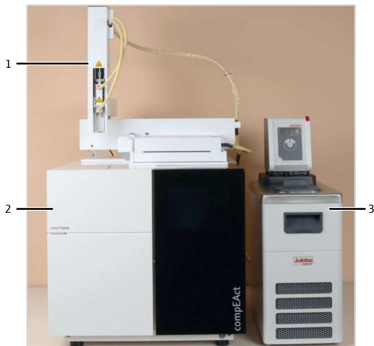
**Fig. 1** Système d'analyse avec distributeur d'échantillons thermostatisable
