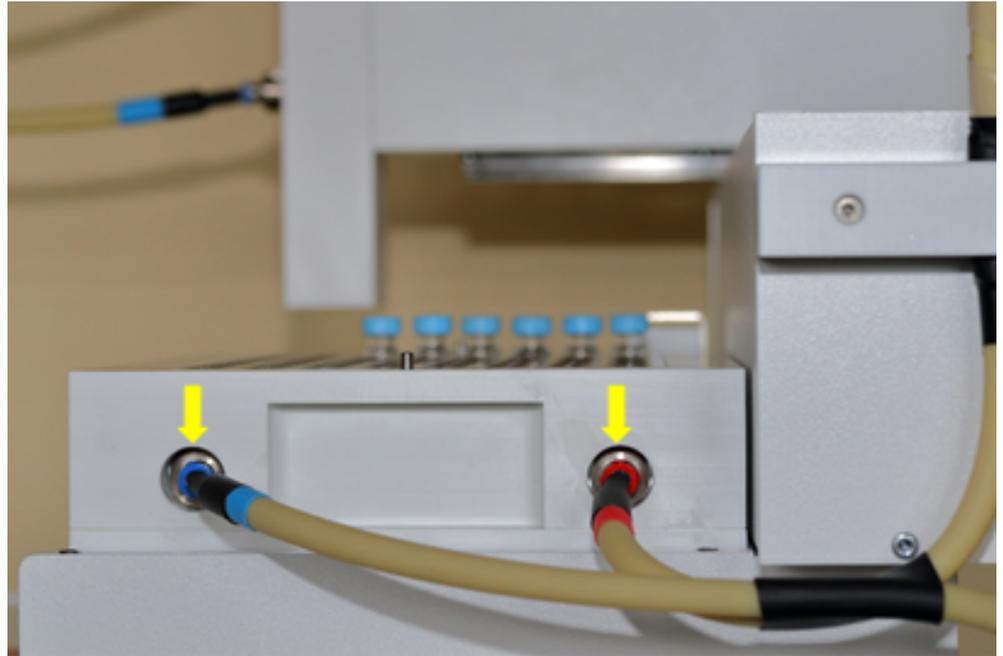
Fig. 22 Raccord sur la tablette porte-échantillons thermostatizable
