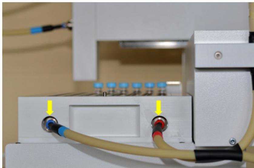
**Abb. 22 Anschluss am temperierbaren Probenblett**
