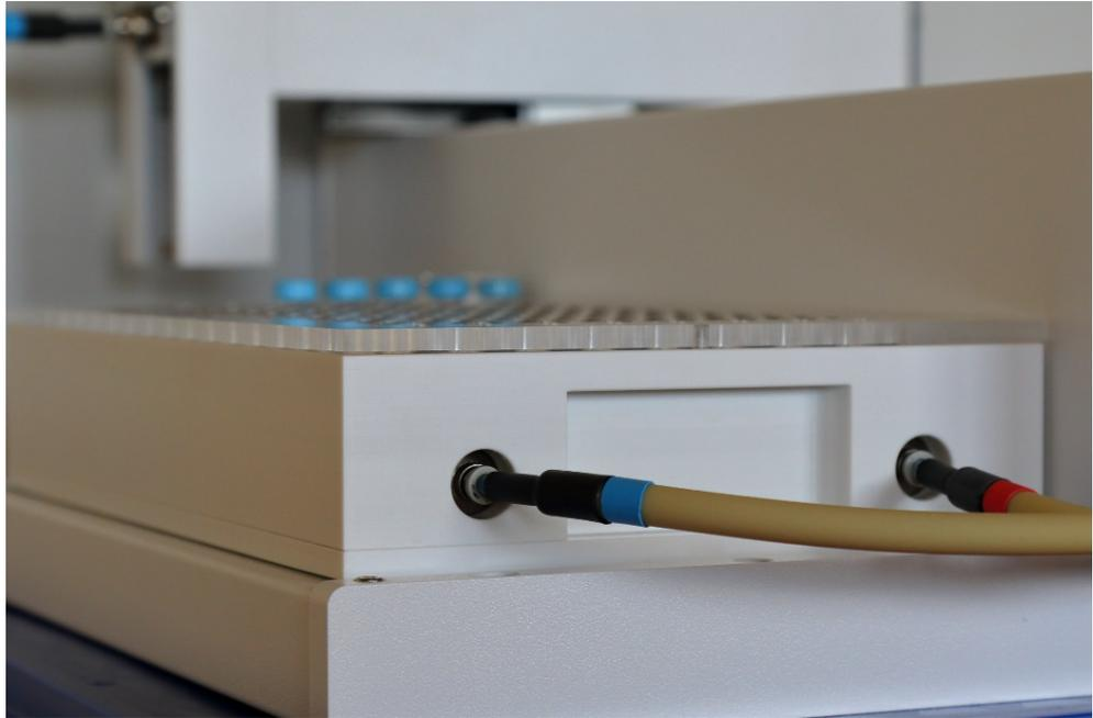
**Abb. 16 Temperierbares Probentablett - Anschlüsse**
