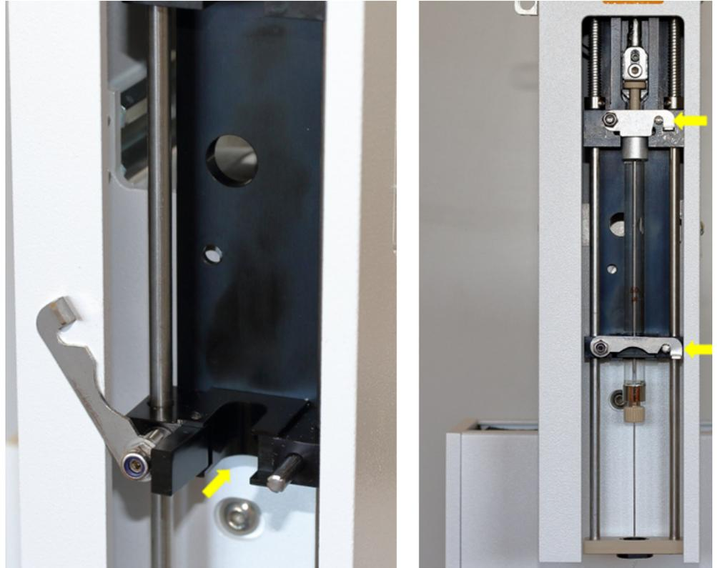
Abb. 23 Spritzenadapter und Verriegelungslaschen
