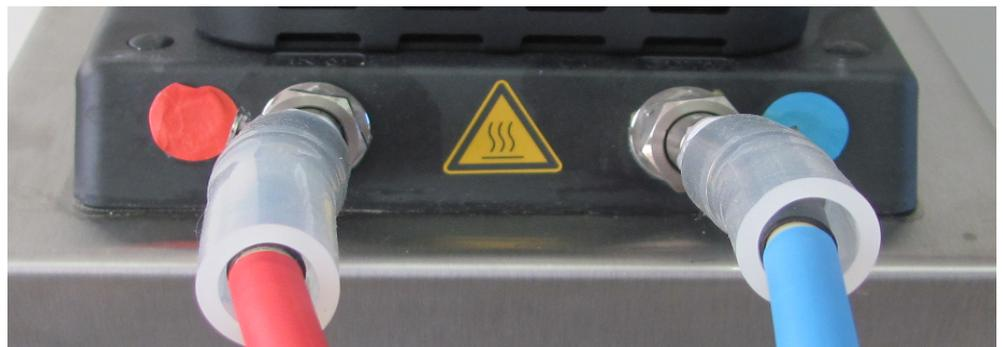
**Abb. 18 Thermostat - Anschlüsse an der Rückseite**
