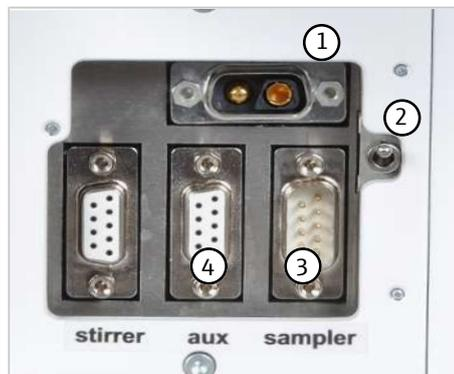
Abb. 13 Rückseite – Anschlüsse
