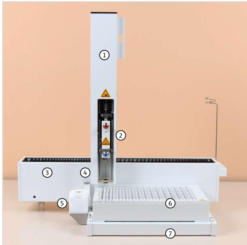
**Abb. 2 Hauptkomponenten des Probengebers**
