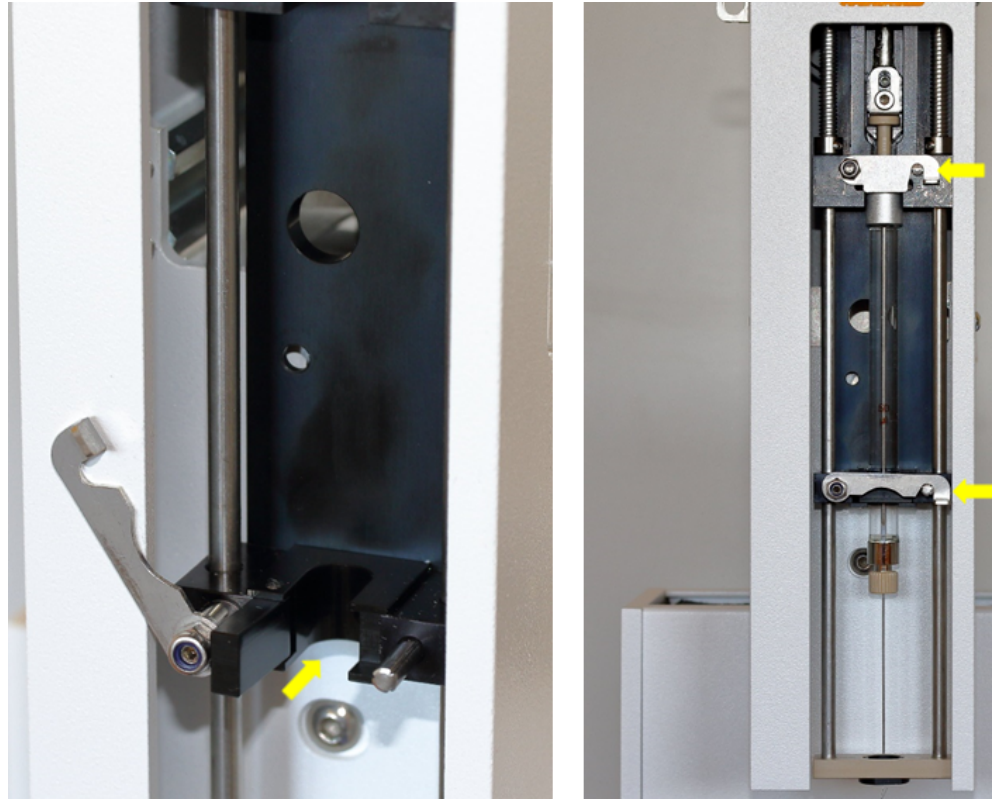
Fig. 24 Adaptador de jeringa y pestañas de bloqueo
