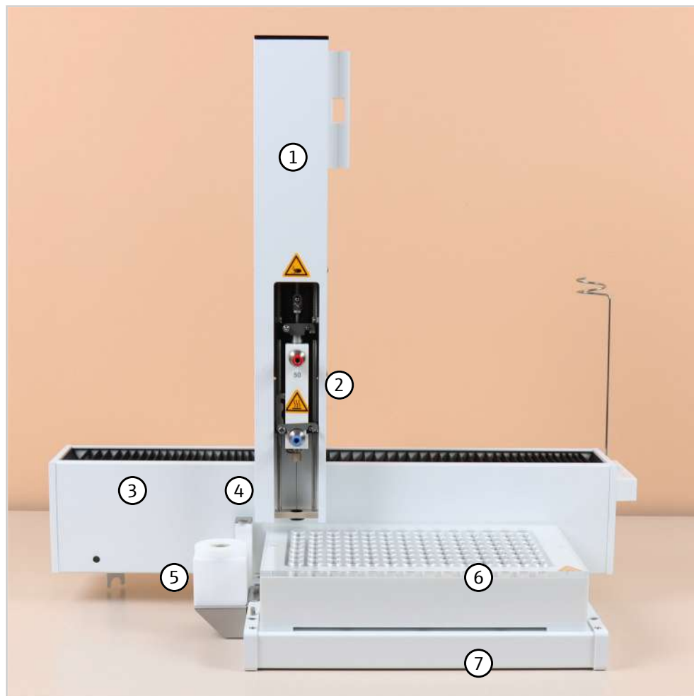
Fig. 2 Principales componentes del automuestreador
