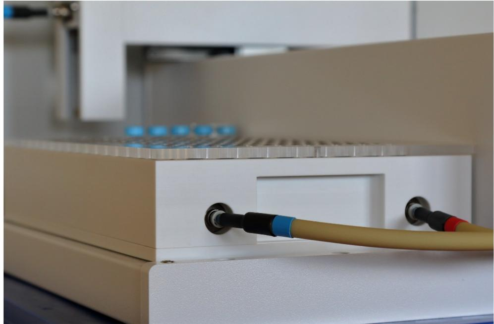
**Abb. 17 Temperierbares Probentablett - Anschlüsse**
