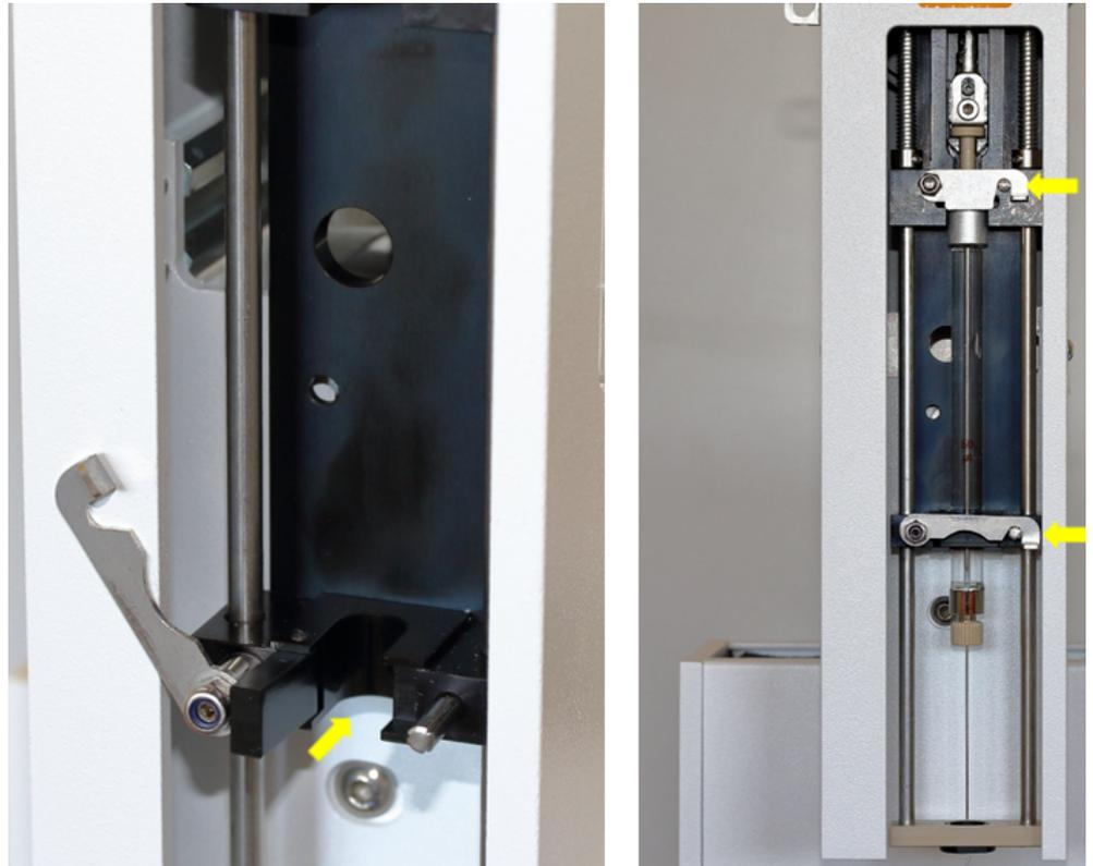
Abb. 24 Spritzenadapter und Verriegelungslaschen
