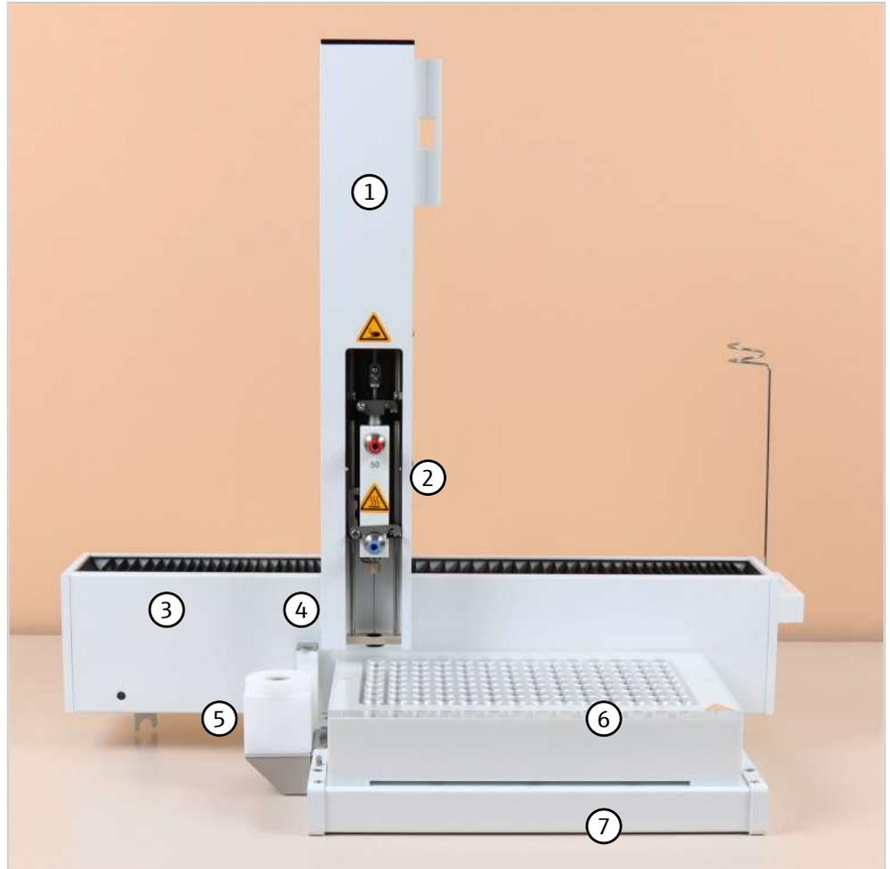
**Abb. 2 Hauptkomponenten des Probengebers**
