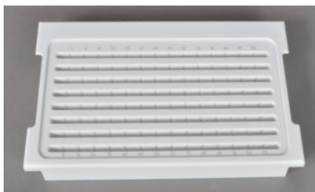
**Fig. 10** Bandeja de muestras para muestras AOX
