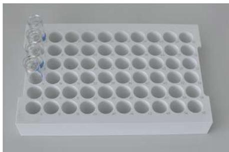
**Fig. 9** Bandeja de muestras para muestras TOC
