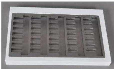
**Fig. 8** Bandeja de muestras para muestras AOX, sólidos, líquidos altamente viscosos
